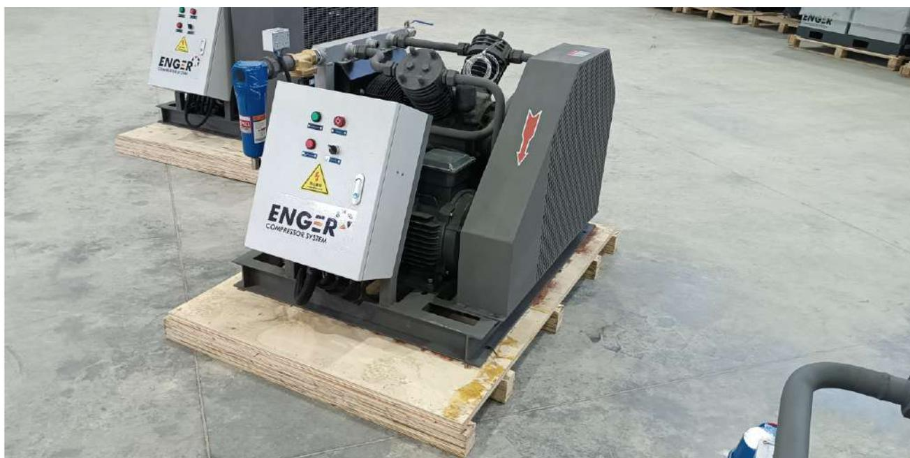
Бустеры этой серии предназначены для увеличения давления сжатого воздуха с 10-13 бар до 40 бар, что необходимо для решения целого ряда производственных задач (выдвиг ПЭТ-тары, сжатие прессы, буровые установки и подобные). Предусмотрены масляное и безмасляное исполнение: сделайте выбор в зависимости от требований к качеству сжатого воздуха на выходе.
