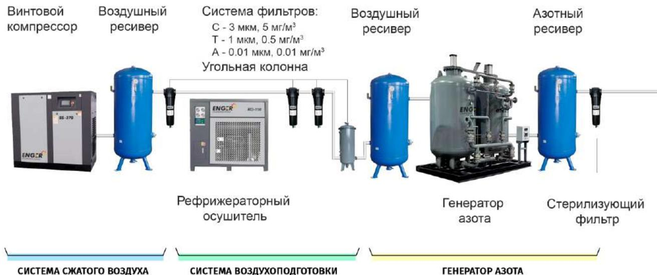
ВАРИАНТ 2: С РЕФРИЖЕРАТОРНЫМ И АДсорбЦИОННЫМ ОСУШИТЕЛЕМ.
