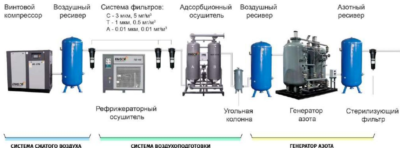
Использование адсорбционного осушителя уменьшает износ молекулярного сита генератора азота. Вследствие этого увеличивается срок службы генератора азота.
